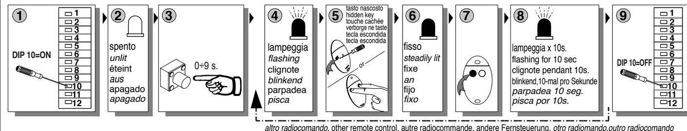
PROGRAMMAZIONE TRASMETTITORI AUTOMATICA, AUTOMATIC TRANSMITTER PROGRAMMING, PROGRAMMATION AUTOMATIQUE EMETTEURS, PROGRAMACION DE TRANSMISORES EN AUTOMATICA, AUTOMATISCHE PROGRAMMIERUNG DER SENDER, PROGRAMAÇÃO AUTOMÁTICA DOS TRANSMISORES.
