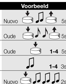
**N.B.:** Als het opslaan in het geheugen tot een goed einde is gekomen, zult u 3 lange geluidssignalen horen. Wanneer het geheugen vol is (30 zenders), zullen 6 geluidssignalen aangeven dat de zender niet in het geheugen kan worden opgeslagen.
