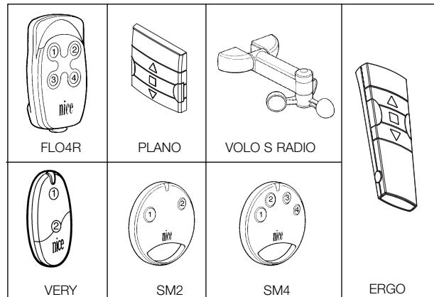
Poiché le codifiche dei trasmettitori sono diverse e la centrale non può riconoscerle simultaneamente, il primo trasmettore memorizzato determina il tipo di codifica e quindi i trasmettitori che si potranno memorizzare in seguito.
