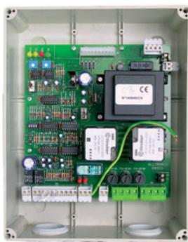
Centrale di controllo trifase per cancelli scorrevoli con chiusura automatica, funzione condominiale, passo-passo e prelampeggio. Ingresso per fotocellule e scheda intermittenza per lampeggiatore. Alimentazione 380V. Completa di armadio 198x251x110mm.
