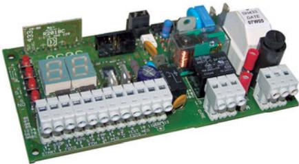
Centrale di controllo multifunzione per cancelli scorrevoli, completa di display per la programmazione e la segnalazione automatica delle anomalie. Funzioni di apertura pedonale, chiusura automatica, passo-passo, prelampeggio, uso condominiale e soft start. Regolazione digitale della forza motore e dei tempi di manovra e di rallentamento. Ricevitore radio integrato frequenza 433.92Mhz, con autoapprendimento dei codici fino a un massimo di 50. Alimentazione 230V~50Hz o 110V~60Hz.
