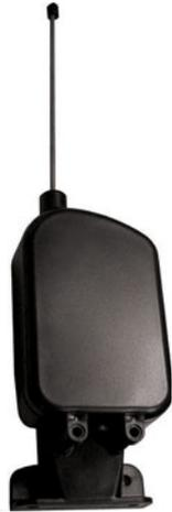
Ricevitore radio supereterodina 1 canale, ad autoapprendimento, completo di antenna. Frequenza 433.92Mhz. 9 codici memorizzabili. Alimentazione 12V/24V.
